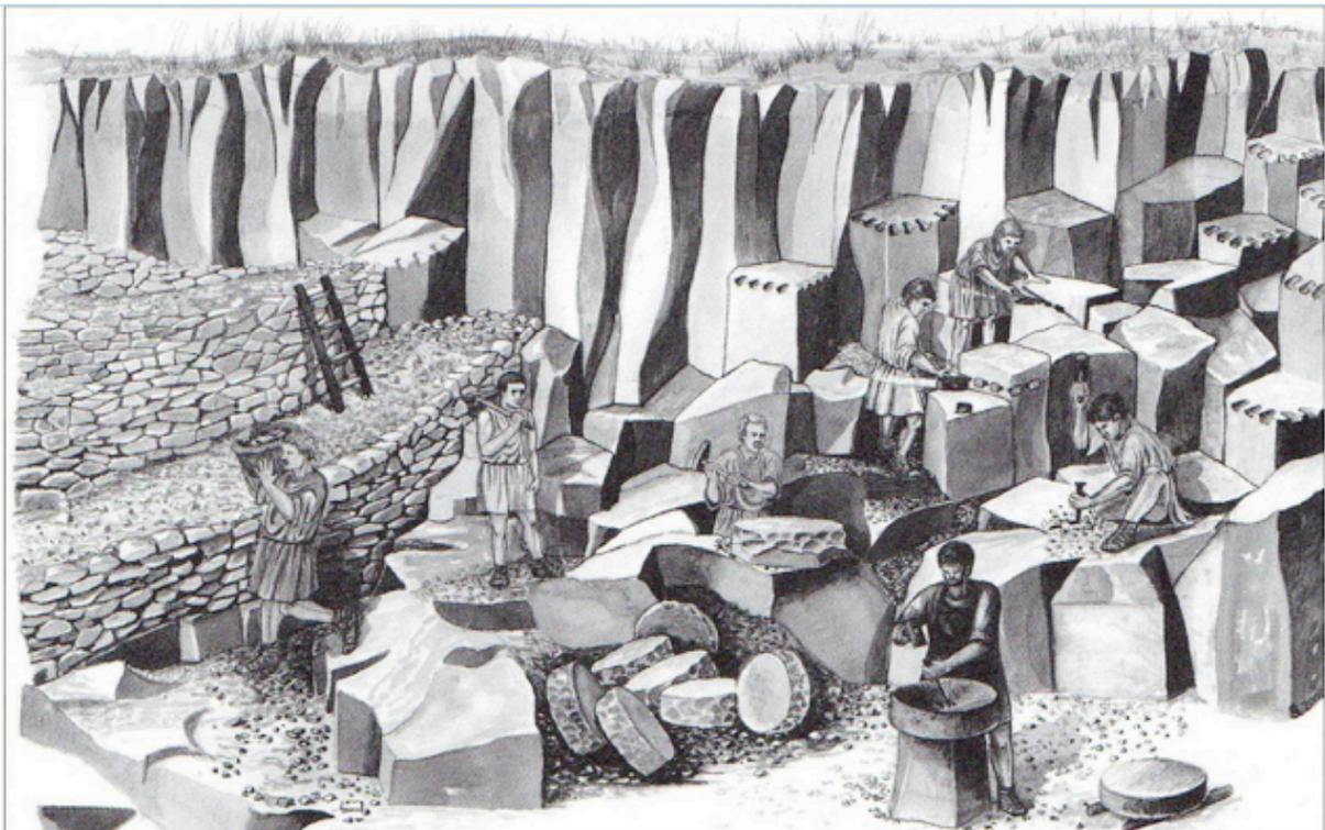
Fig. 9 : la meulière romaine de Mayen (d'après Mangartz 2006, p. 30 : fig. 6). Sur les fronts de taille, on peut observer les traces d'emboiture à la base de chaque colonne.
